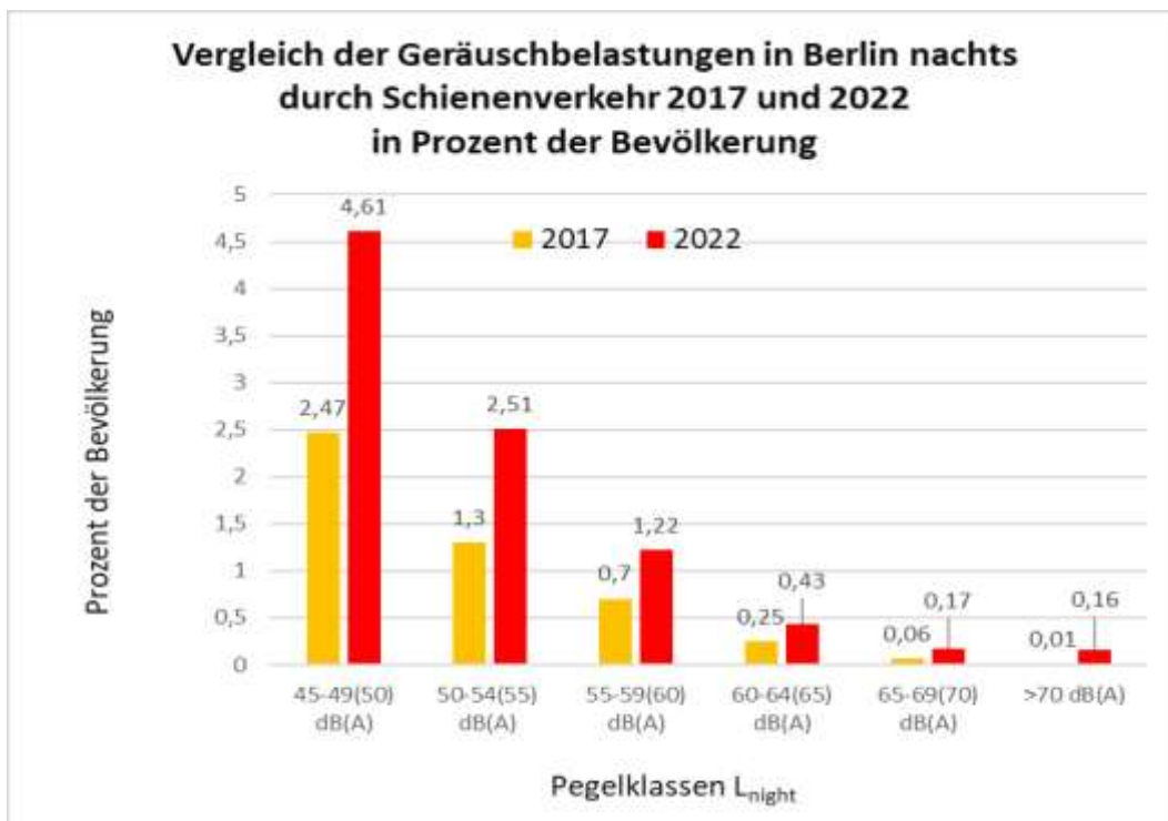
Abb. 2.4: Vergleich der Geräuschbelastungen in Berlin nachts durch Schienenverkehr 2017 und 2022 in Prozent der Bevölkerung. Eigene Darstellung nach Daten des EBA: EBA (2018): Lärmaktionsplan Teil A an Haupteisenbahnstrecken des Bundes – 2017/2018 EBA (2023): Entwurf Lärmaktionsplan des Eisenbahn-Bundesamtes – Runde 4
